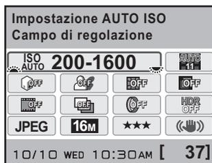
**3** Usate la ghiera elettronica anteriore (☀️) o posteriore (☀️) per cambiare l'impostazione.
