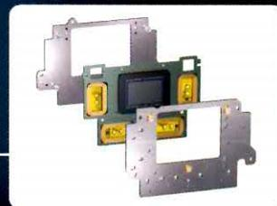
Il sistema di Shake Reduction della Pentax K20D è stato progettato per compensare i movimenti della fotocamera durante lo scatto, garantendo immagini nitide e stabili. Questo sistema è integrato nella fotocamera e funziona con qualsiasi obiettivo montato.
