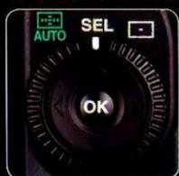
La messa a fuoco precisa è cruciale per la forza espressiva di una foto. La K20D impiega un sistema autofocus a 11 punti. In modalità automatica la fotocamera riconosce l'oggetto più vicino e mette a fuoco su di esso. Ciascuno degli 11 punti può essere scelto manualmente e venire visualizzato in base al modo operativo che si preferisce. È anche possibile impostare la sola messa a fuoco centrale.
