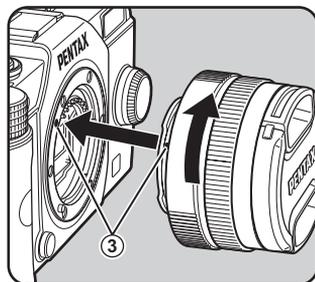
Una volta innestato l'obiettivo, provate a ruotarlo in senso antiorario per verificare che sia bloccato in posizione.
