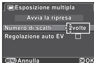
**4** Utilizzate il selettore a 4-vie (▲ ▼) per selezionare [Regolazione auto EV], quindi utilizzate il selettore a 4-vie (◀ ▶) per selezionare  o .
