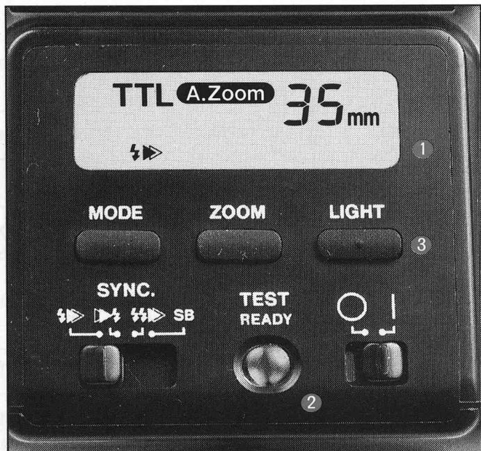
Quando l'AF330FTZ è montato sulla fotocamera, premendo a metà corsa il pulsante di scatto di quest'ultima, avviene lo scambio di informazioni che consente l'attivazione delle funzioni dedicate.
